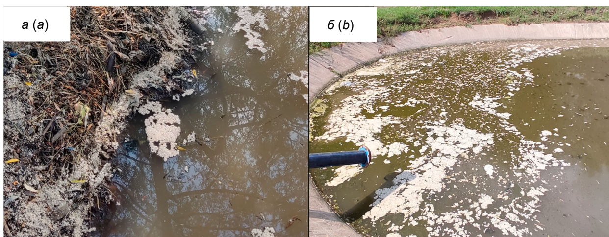
Рис. 5. Загрязнение полистиролом очистных сооружений в районе ул. Семашко: а – загрязнение прибрежной зоны; б – образование полистирольных пятен на поверхности воды
