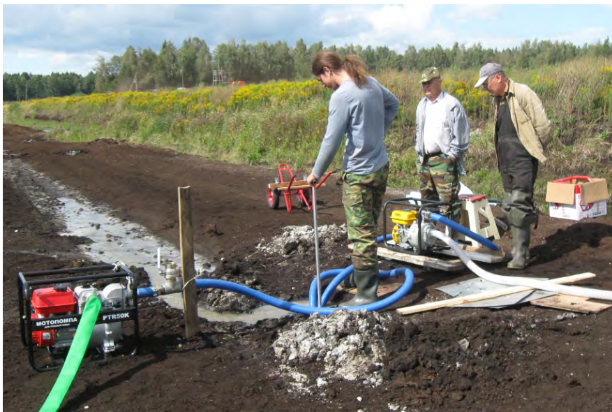
Рис. 3. Испытания скважинного способа добычи сапропеля на торфяном месторождении Гала-Ковалевское Пуховичского района Минской области
