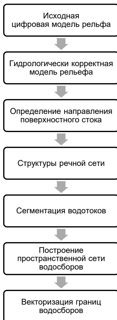
Рис. 1. Концептуальная схема моделирования
